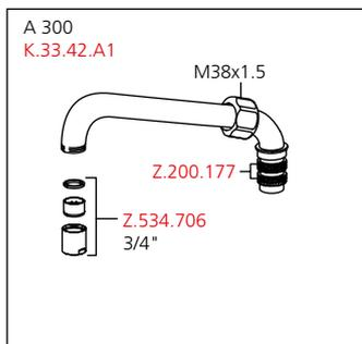
**Auslaufmenge 50 l/min (3 bar)
