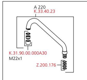
Auslaufmenge 12 l/min (3 bar)
