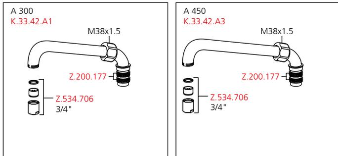
Auslaufmenge 120 l/min (3 bar)
