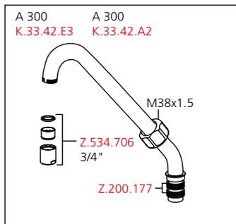
Auslaufmenge 88 l/min (3 bar)
